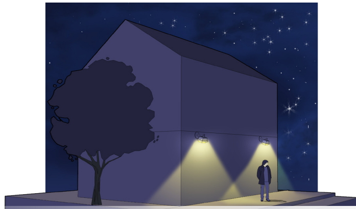
Éclairage bon : le flux est dirigé du haut vers le bas, la végétation n'est pas éclairée et la pollution lumineuse est limitée.
